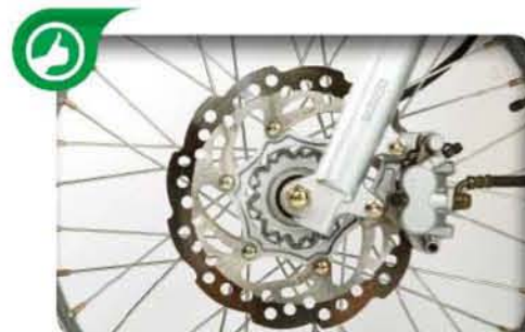
“La pinza de freno delantera de doble pistón es radial y ataca un disco lobulado de 280 mm”.
